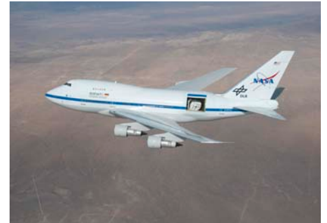
SOFIA mit geöffneter Teleskoptür in einer Flughöhe von etwa fünf km über der Mojave-Wüste (Kalifornien) (Foto: NASA)
