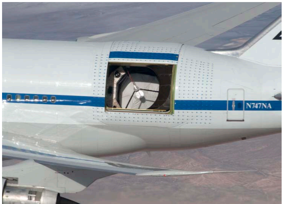
Großaufnahme der geöffneten Teleskoptür. Der 2,7 m große Hauptspiegel (Foto: NASA)
